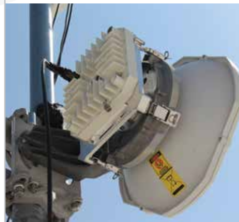
Радиомодуль Liberator-E1000e для диапазона E-band
