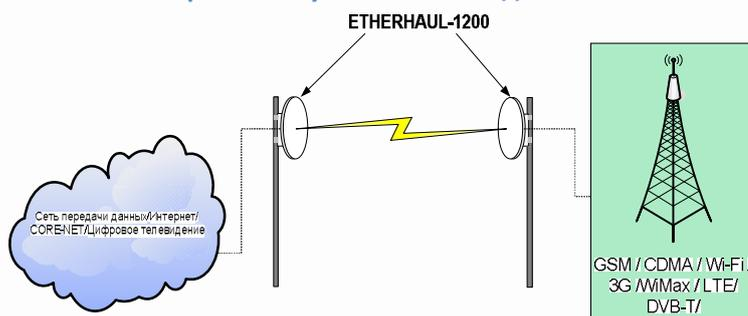
EtherHaul-1200 как решение транспортного канала в сетях беспроводного доступа
