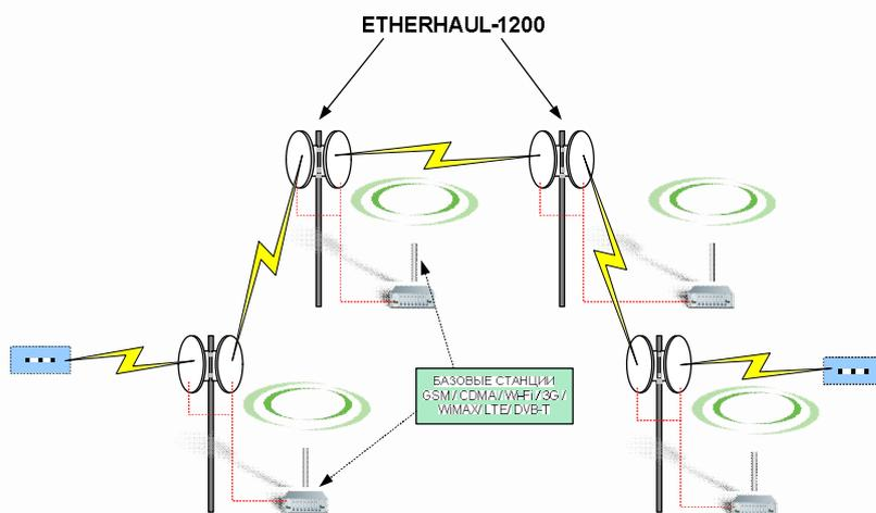
Вставка линка EtherHaul-1200 на оптоволоконной трассе.
