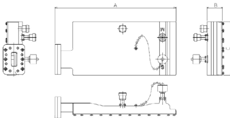
Рисунок 10.10 (а) Ответвитель для полос 7/8 ГГц (тип разъема N)
