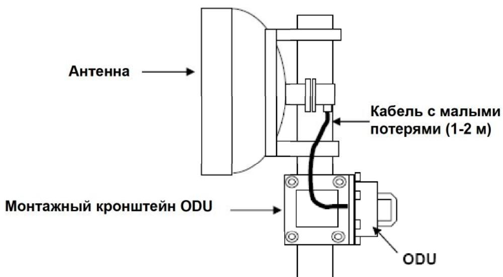
Рисунок. 5.6(б) 6/7/8 ГГц, отдельный монтаж ODU PASOLINK 1+0
