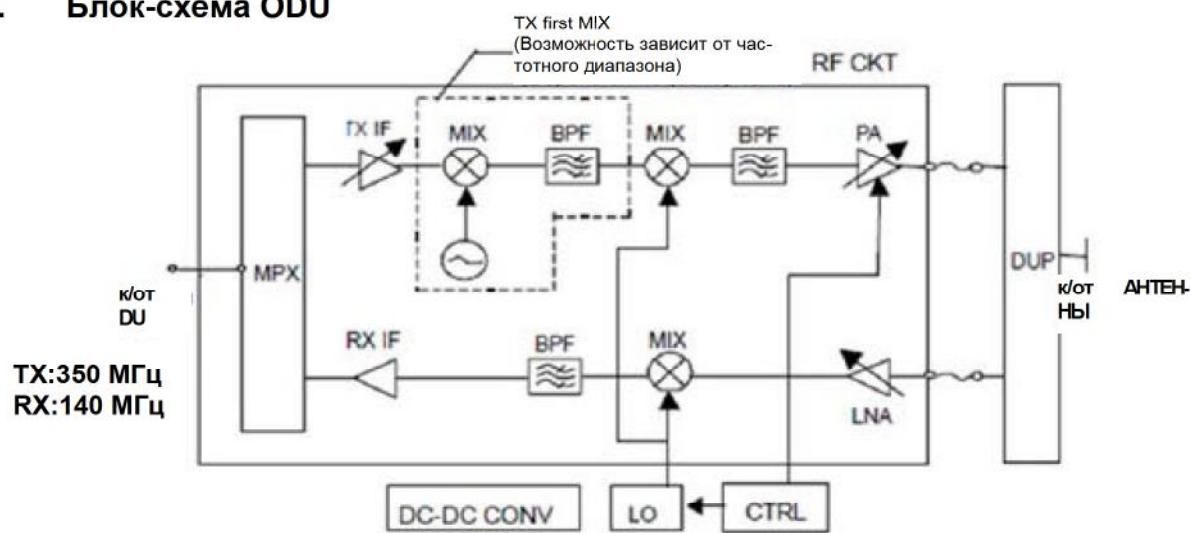
Рисунок 5.5 Блок-схема ODU
