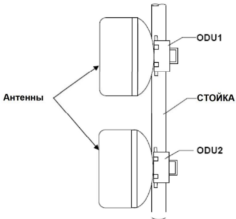
Рисунок. 5.6(д) 7 – 38 ГГц, прямой монтаж ODU PASOLINK 1+1
