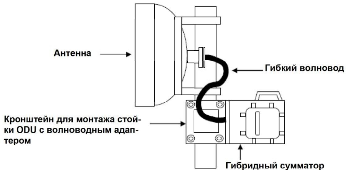
Рисунок. 5.6(е) 7 – 38 ГГц, отдельный монтаж ODU PASOLINK 1+1, с гибридным сумматором
