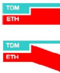
Технологию PWE следует использовать для сервисов, не чувствительных к джиттеру и времени задержки, или в случае если в мобильной сети RAN тактовая синхронизация обеспечивается за счет других способов синхронизации.
