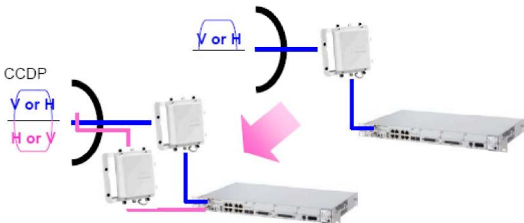
Рисунок 3.2 Удвоение емкости при обновлении
