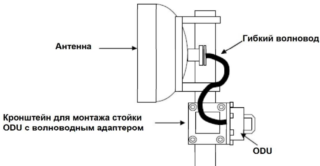
Рисунок. 5.6(а) 6 – 38 ГГц, отдельный монтаж ODU PASOLINK 1+0
