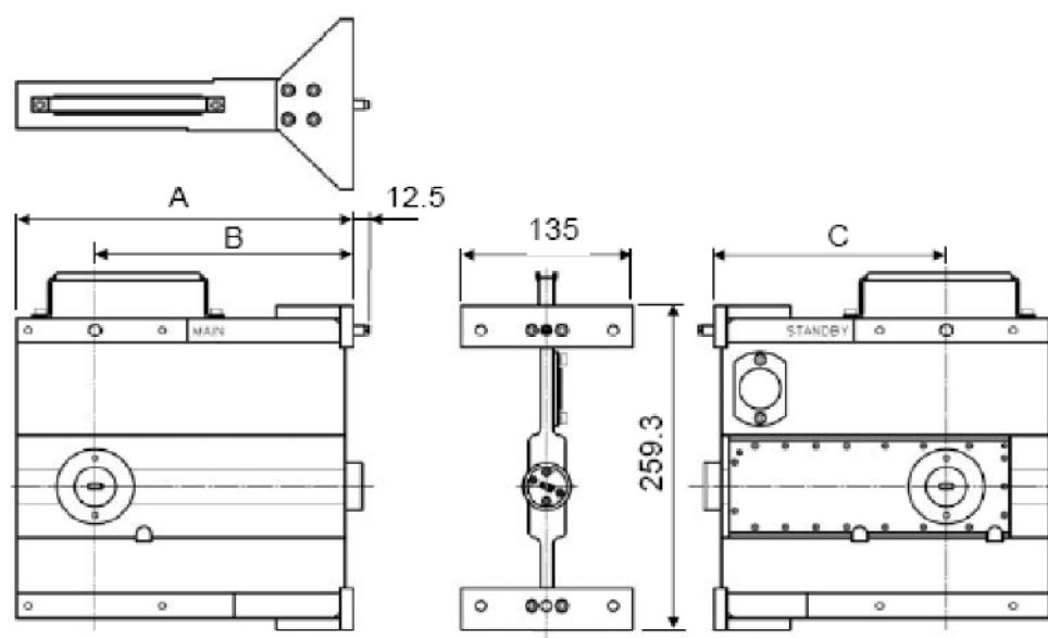
Рисунок 10.4 10 – 38 ГГц, гибридный сумматор/делитель
