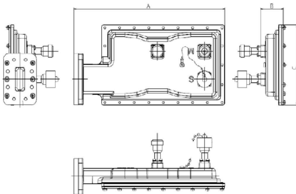
Рисунок 10.3 (b) HYB для полос 7/8 ГГц (тип разъема N)
