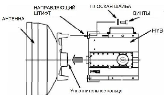
**Рисунок 10.6 Антенна и гибридный сумматор/делитель (вид сбоку)**
