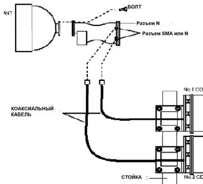
**Рисунок 10.5 Сумматор/делитель для полосы 6/7/8 ГГц**
