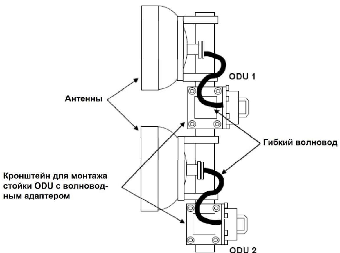
Рисунок. 5.6(ф) 6 – 38 ГГц, отдельный монтаж ODU PASOLINK 1+1 с двумя антеннами
