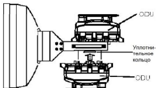
**Рисунок. 10.7 Антенна, ODU и гибридный сумматор/делитель (Общий вид)**
