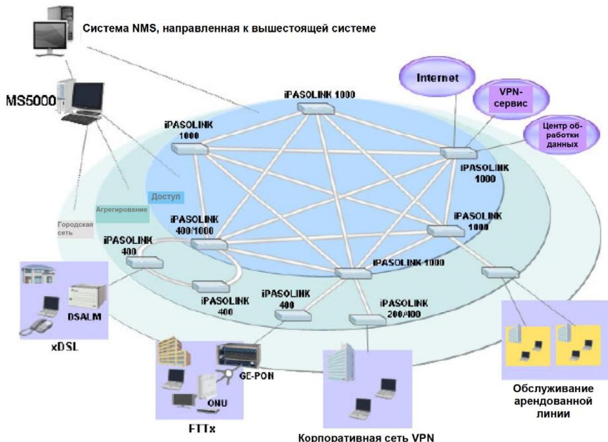
Рисунок 4.3 Усовершенствованная городская сеть, оснащенная iPASOLINK 400 и iPASOLINK 1000
