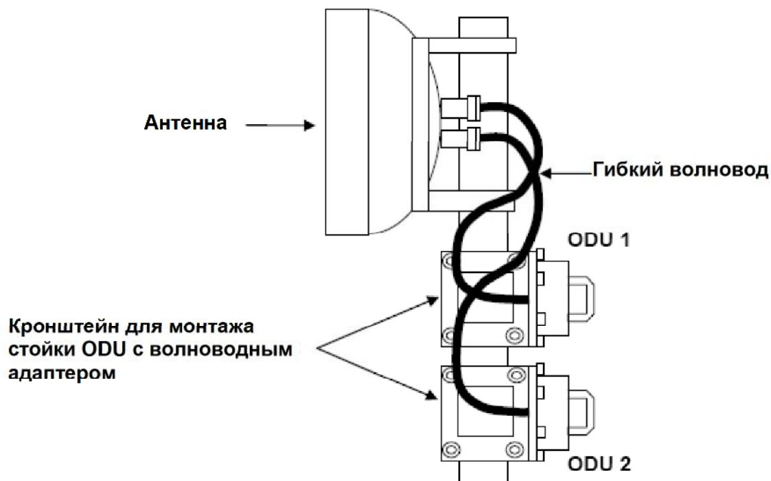
Рисунок. 5.6 (к) 6 – 38 ГГц, отдельный монтаж системы с двойной поляризацией
