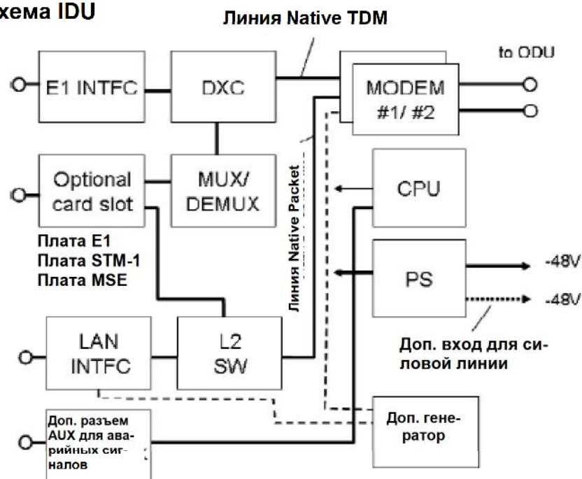
Рисунок 5.4 Блок-схема IDU
