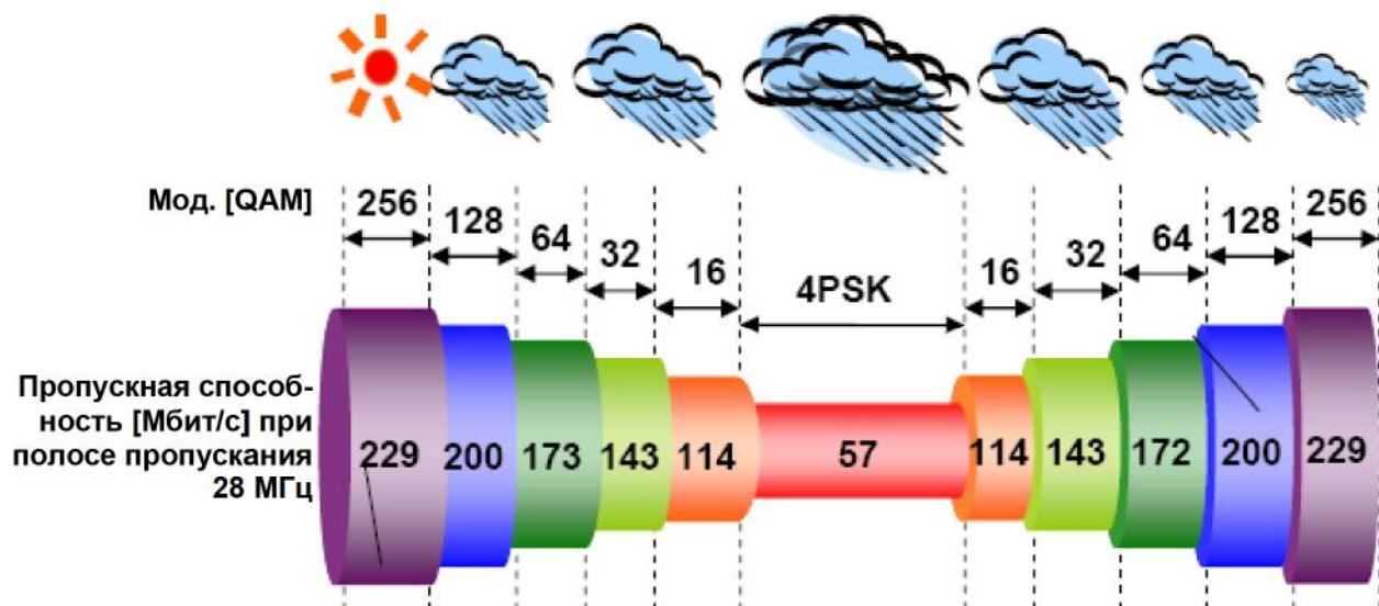
Рисунок 3.1 Схема изменения емкости AMR
