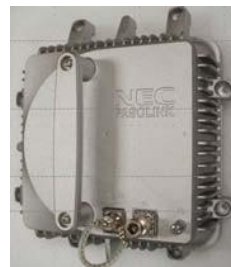
Рисунок 5.1.3 Блок ODU, работающий в диапазоне 6 – 11 ГГц
