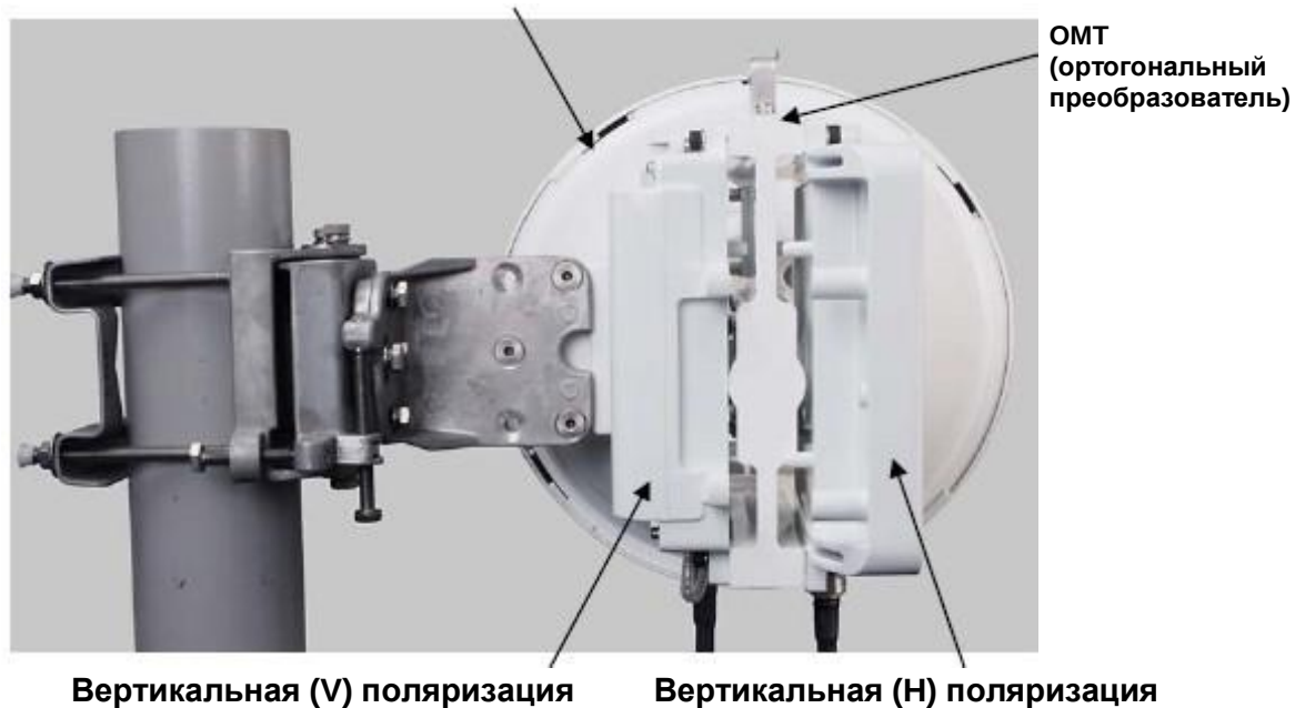
Рис. 5.4.1 (j) 11 – 38 ГГц, прямой монтаж для системы с двойной поляризацией
