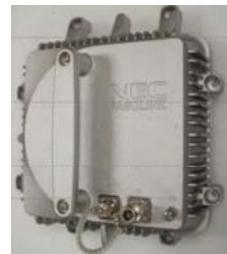
Рисунок 5.3 ODU, работающий в диапазоне 6 – 11 ГГц
