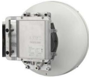
Рисунок 5.2 ODU, работающий в диапазоне 13 – 42 ГГц, и монтируемая напрямую антенна диаметром 0,3 м
