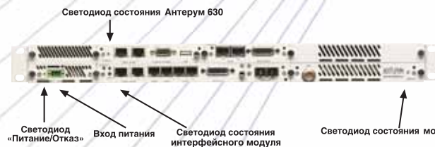
Рисунок 2. Передняя панель внутреннего блока Антерум 630 конфигурации 1+0. Светодиоды состояния.
